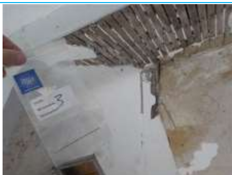
Matériaux : ZPSO-003 Prélèvement : P003 Description : Enduit plafonds / murs Localisation : 2ème étage - Pièce 1 Résultat : Absence d'amiante
